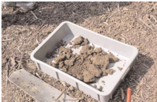
Prüfen des zusammenhaltes zwischen den Aggregaten mittels Fallprobe
