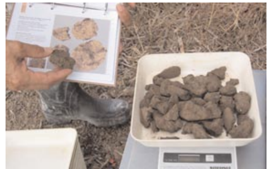
Bestimmen der Aggregattypen und wiegen der einzelnen Fraktionen
