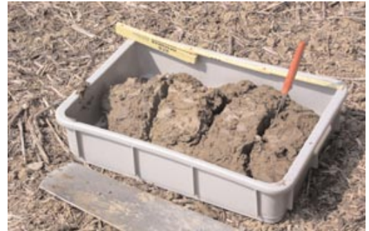
Aufteilen der Probe in 12 cm dicke Schichten
