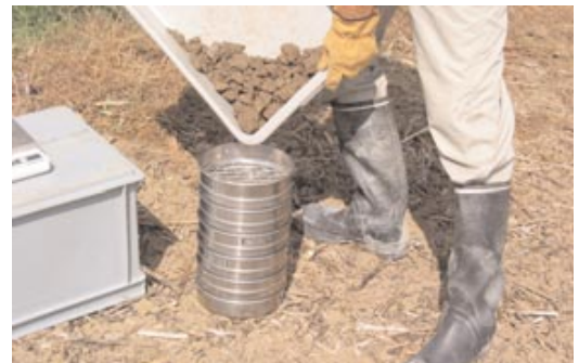
Fraktionieren der Grössenklassen mittels Siebkolonne.
